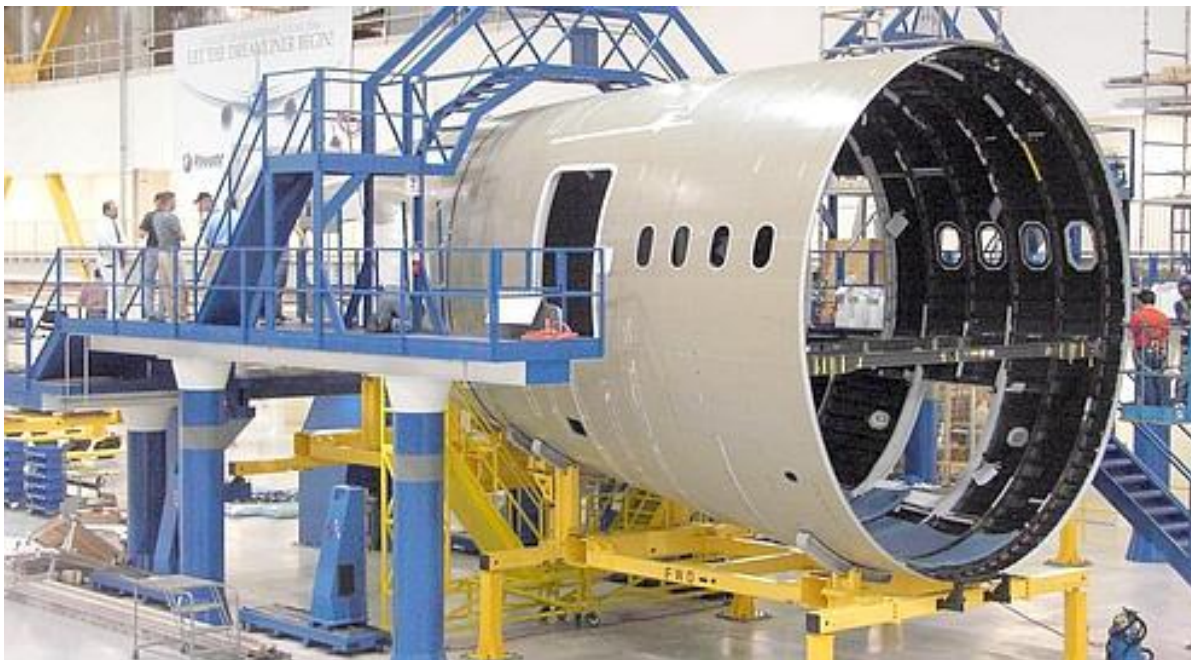
Abb. 7: Teil des Rumpfes der BOEING 787 Dreamliner
