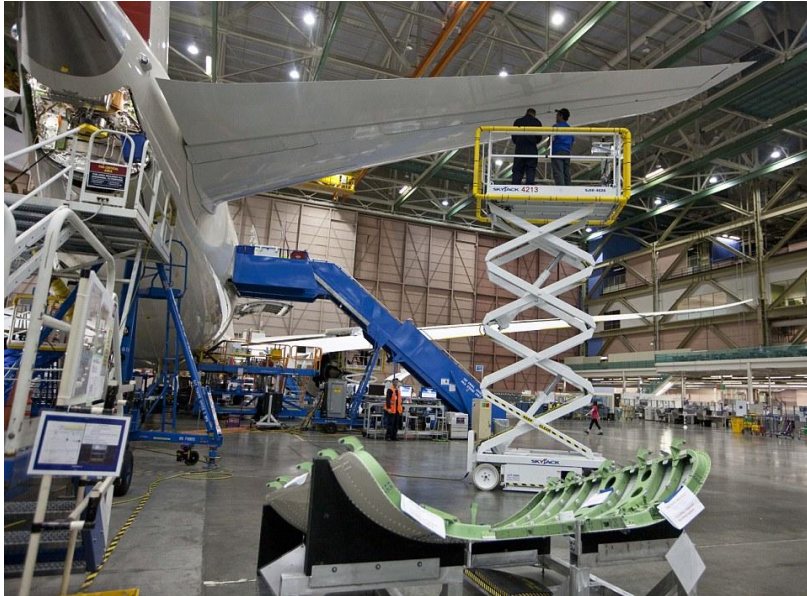
Abb. 6: Montage des hinteren Querruders der Boeing 787 Dreamliner
