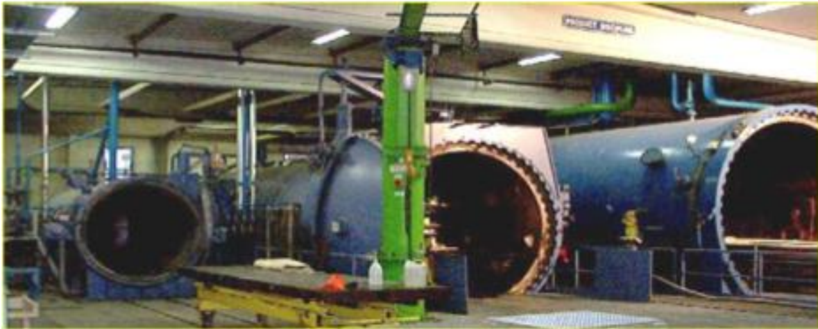
Abb. 13: für Luftfahrtteile verwendete Autoklaven (Dok. Sonaca)
