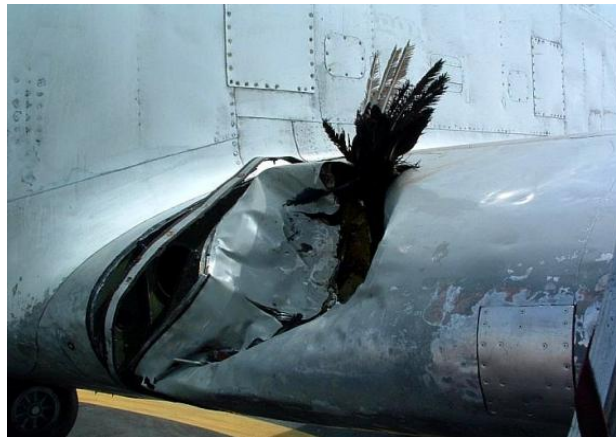
Abb. 4: Aufprall eines Vogels auf die Tragfläche eines Flugzeugs mit Metallstruktur.
