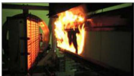
**Principe :** Les échantillons sont maintenus verticalement et exposés à un panneau radiant alimenté par du gaz et à une flamme qui n'entre pas en contact avec leurs surfaces. L'extrémité de l'échantillon la plus chaude reçoit un flux de chaleur radiant
