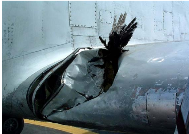
Figure 4 : Impact d'un oiseau sur l'aile d'un avion à structure métallique.
